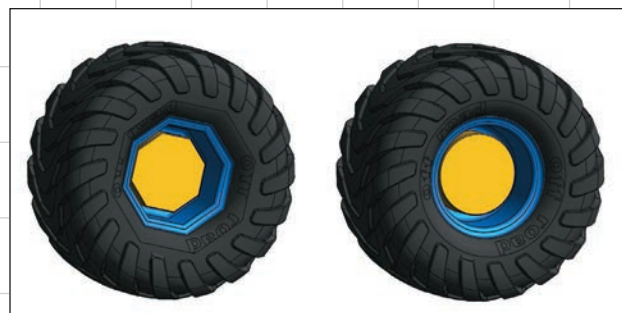
Рис. 42. Изменение точности отрисовки 3D-модели для статичной графики
