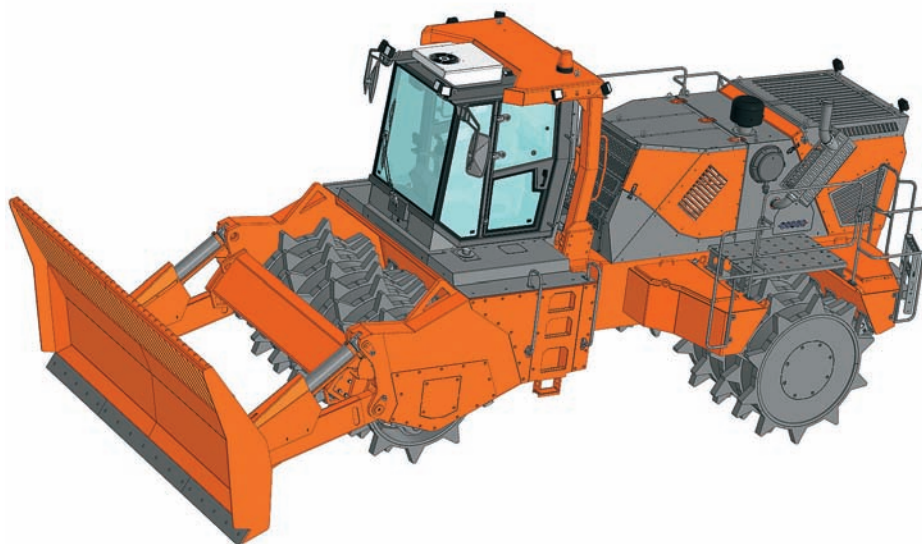
Цифровая модель дорожной машины «Бурлак» ООО «Завод дорожных машин» (Рыбинск), выполненная в КОМПАС-3D
